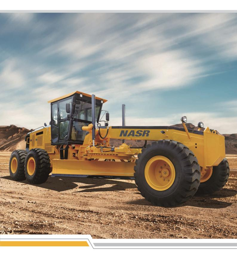
ENGINE MODEL GROSS POWER OPERATING WEIGHT WEICHAI WP7G270E302 199kW @ 2200rpm 18500kg
